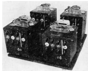
Homéostat Ou Machine Ultra-stable Ashby, 1950
